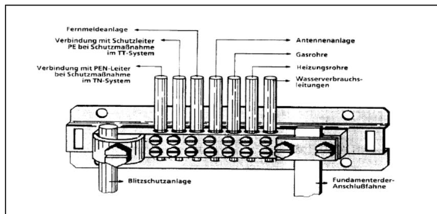
Abbildung 4: Anschlussbeispiele Haupterdungsschiene
