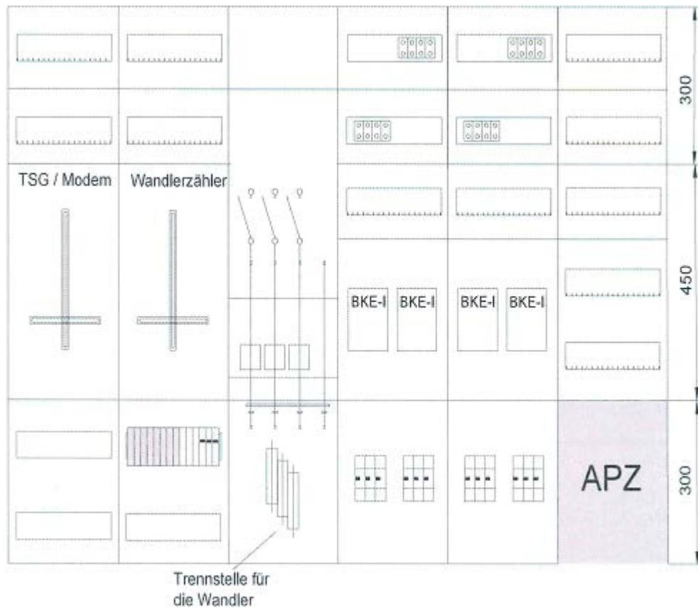
Abbildung 10: Beispielbild Mehrkundenanlage mit Messwandlerschrank
