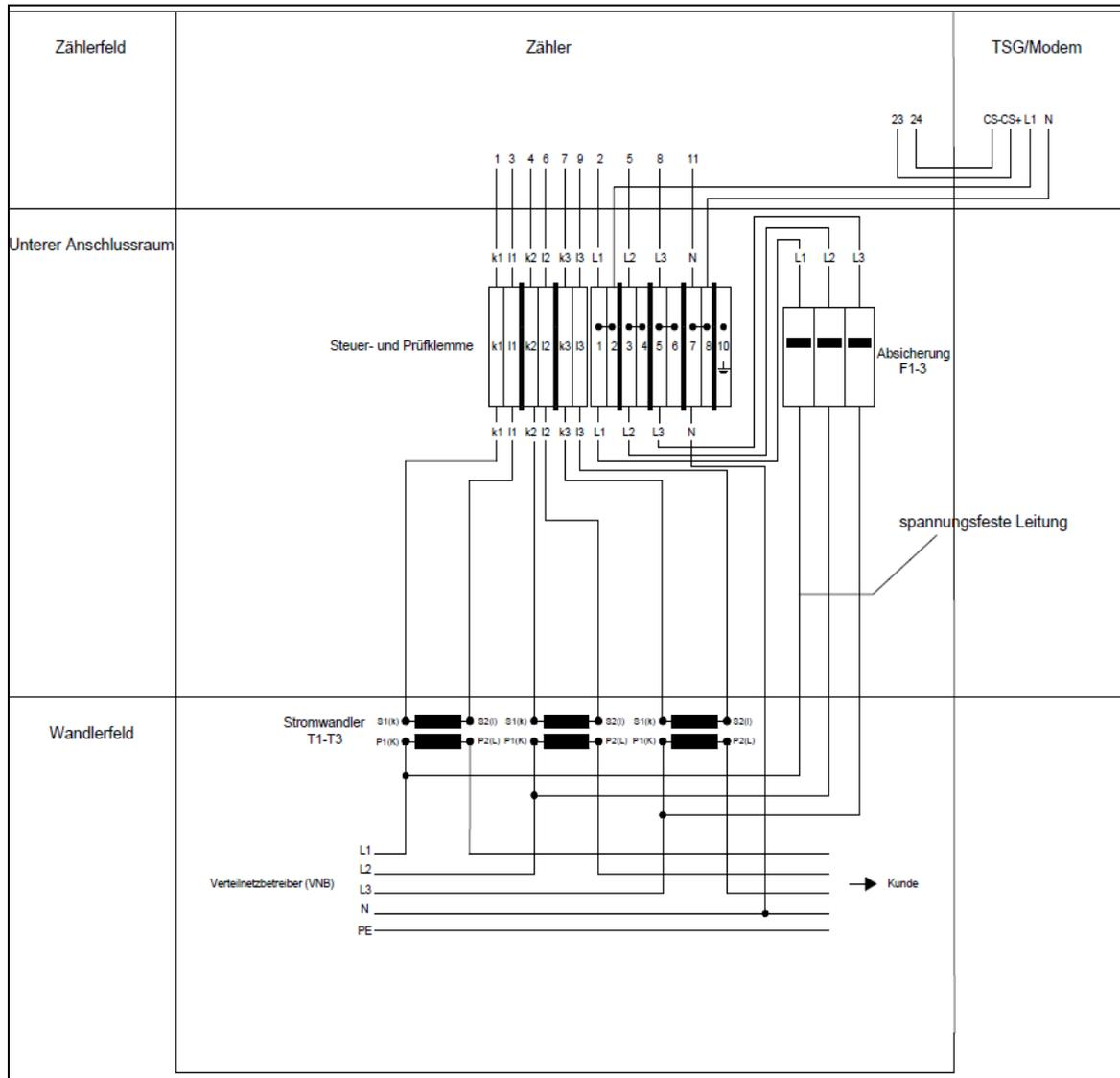
Abbildung 8: Anschlussplan Wandlermessung
