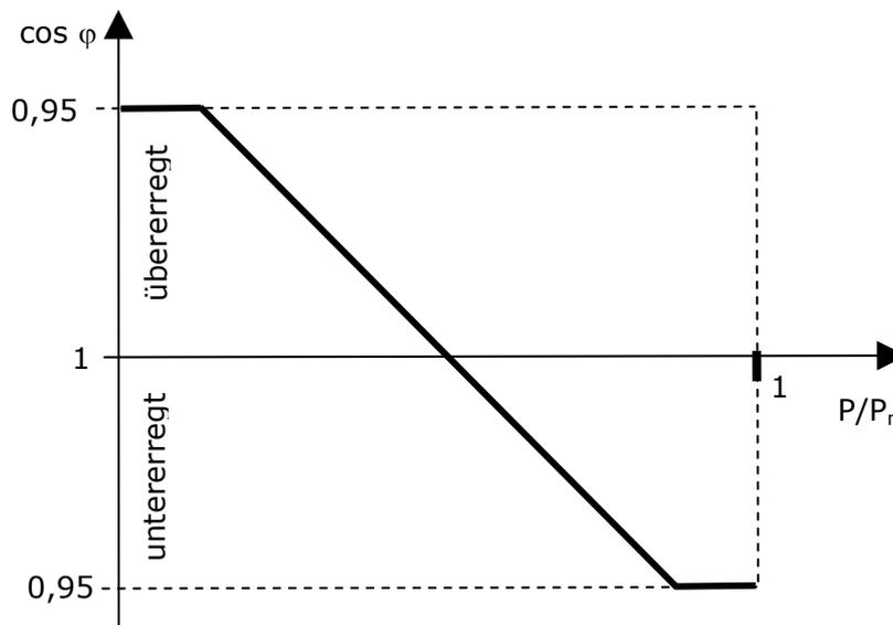
**Bild 2.5.4-1:** Beispiel für eine  $\cos \varphi$  (P)-Kennlinie
