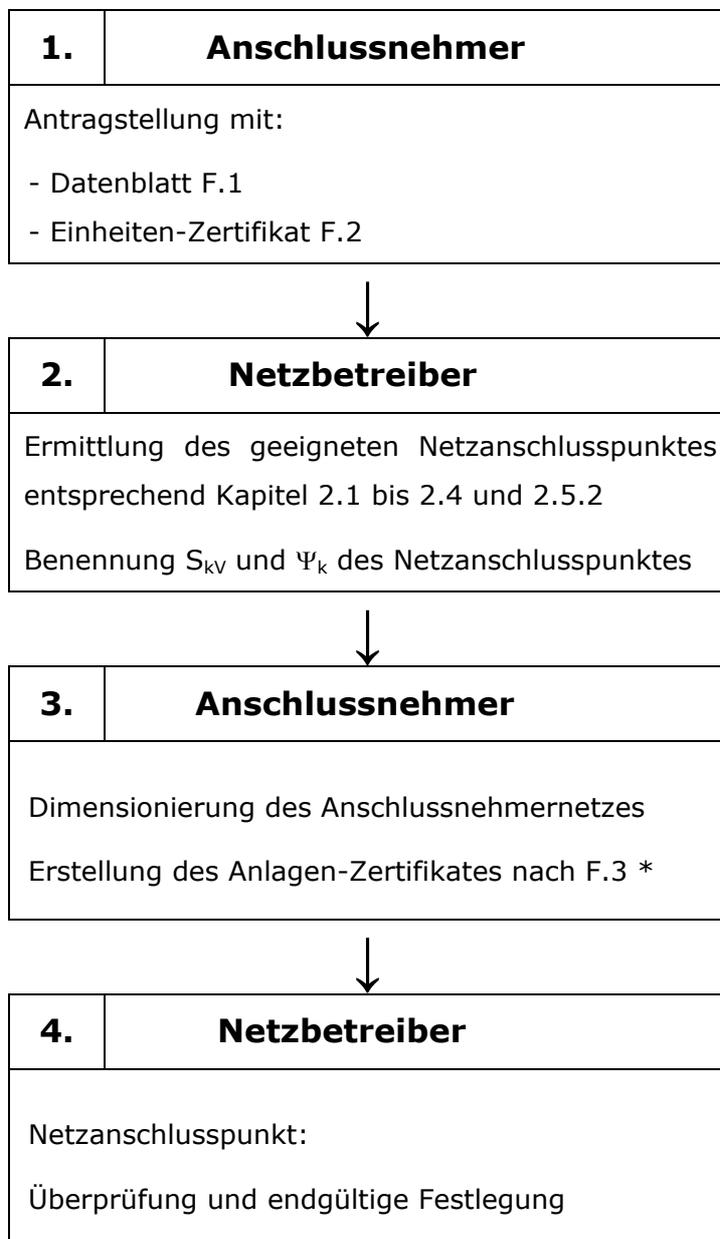
\* Entfällt für Erzeugungsanlagen mit einer Anschlusscheinleistung  $S_A$  von  $\leq 1$  MVA und einer Länge der Anschlussleitung vom Netzanschlusspunkt bis zu der/den Erzeugungseinheit(en) von  $\leq 2$  Kilometern.
