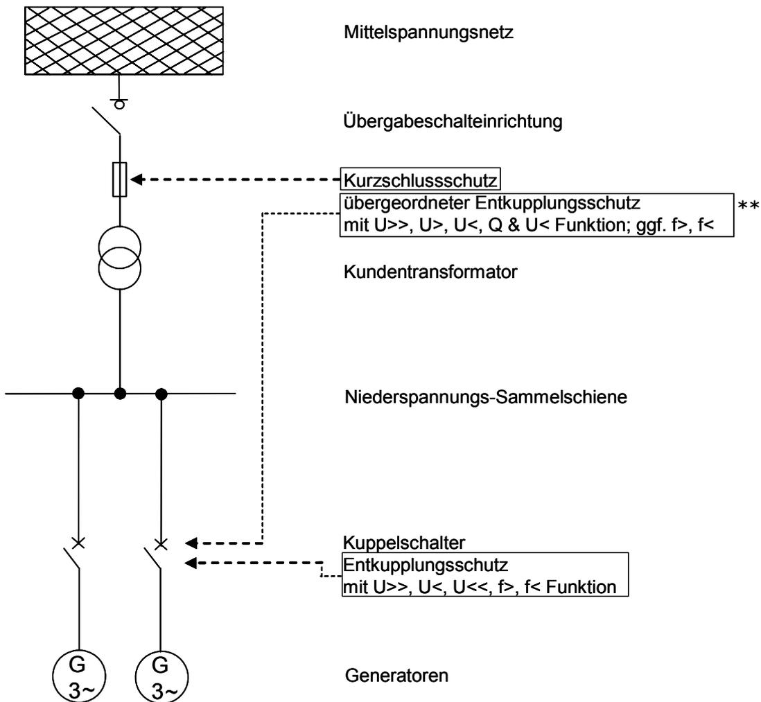
**Bild C.6:** An das Mittelspannungsnetz angeschlossene Erzeugungsanlage mit Lasttrennschalter und mehreren Erzeugungseinheiten ohne Inselbetriebsmöglichkeit
