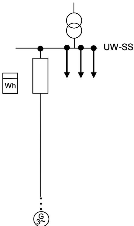
**Bild C.2** Netzanschlusspunkt an der Mittelspannungs-Sammelschiene eines Umspannwerkes
