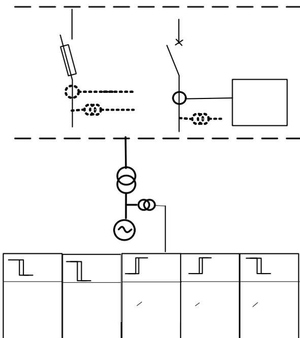
**Bild 3.2.3.4-1:** Schutzkonzept bei Anschluss von Erzeugungsanlagen im Mittelspannungsnetz
