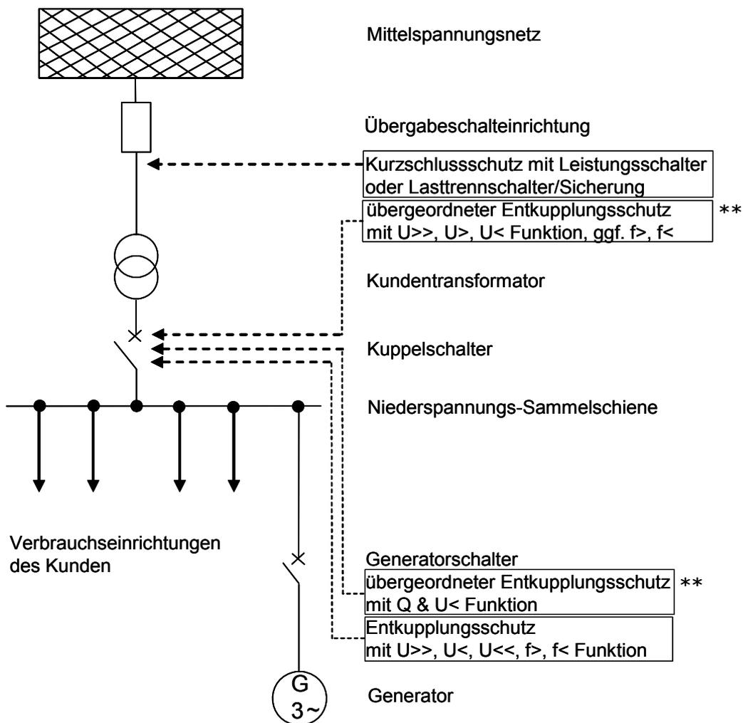
**Bild C.7:** An das Mittelspannungsnetz angeschlossene Kundenanlage mit Erzeugungseinheit und Inselbetriebsmöglichkeit über niederspannungsseitigen Kuppelschalter
